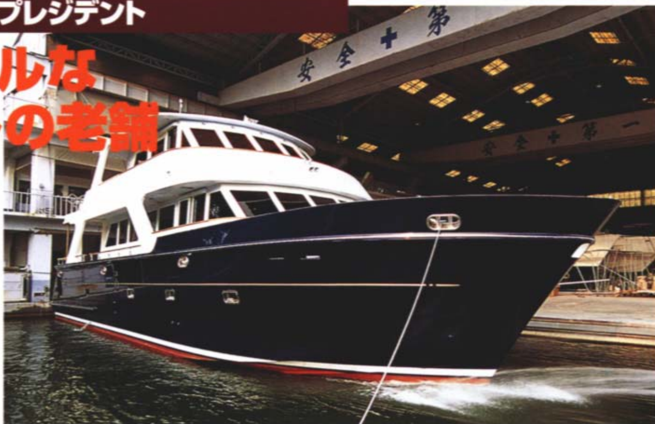
水槽でエンジンテストやコントロールテストを行い、その後シートライアルをしてアメリカのシアトルに輸出される76フィート豪華モーターヨット「レジェンド76」。
